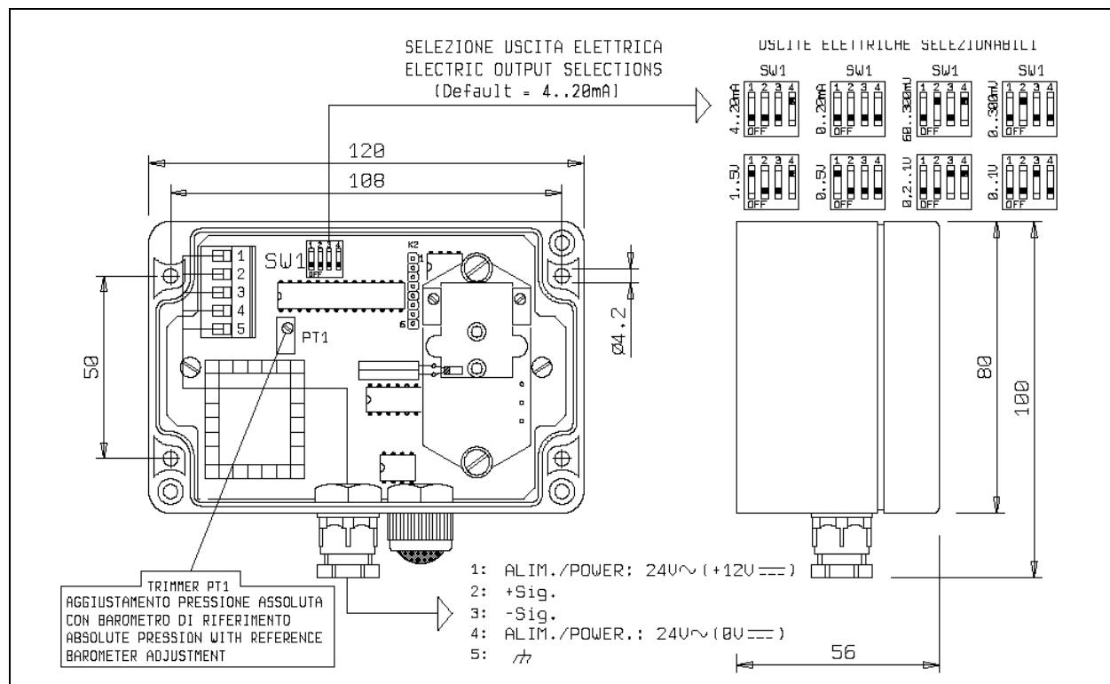
**APPENDICE C – Ingombro e connessioni per modelli DQA24x / Overall dimensions and connections for DQA24x models**
