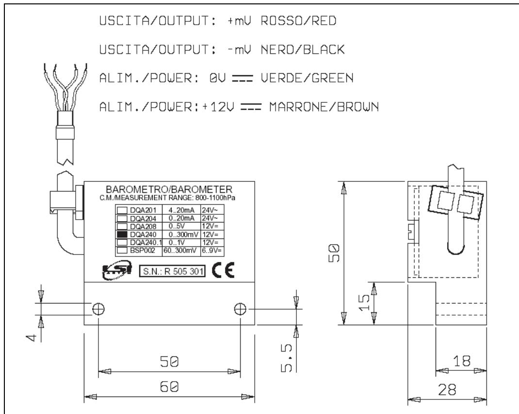
**APPENDICE D – Ingombro e connessioni per modelli DQA25x / Overall dimensions and connections for DQA25x models**
