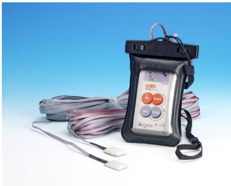
Le dispositif intérieur est équipé d'une sonde de température par contact identique aux deux sondes extérieures et d'une sonde de flux thermique à thermopile. Une fois les mesures effectuées sur une période de plusieurs jours, le calcul d'isolation thermique du bâtiment appelé coefficient U peut être réalisé. Un rapport d'isolation thermique comprenant des tableaux et des graphiques est effectué après téléchargement des données sur un ordinateur PC et au moyen de notre logiciel InfoFlux.
