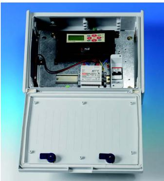
Boîtier IP65 de 30x40 cm pour batteries et alimentation/chargeur (220 Vac / 13,8 Vdc, 50 W).
