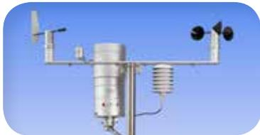
Chaque kit KME comprend un bras en aluminium en forme de T pour installer les capteurs au sommet d'un mât cylindrique d'un diamètre de 65 mm maximum. LSI LASTEM propose une gamme de mâts, pylônes et trépieds pour les applications mobiles ou fixes.
