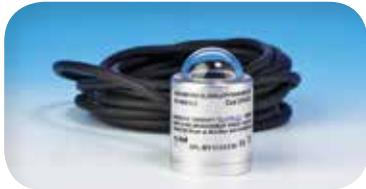
Selon la configuration choisie, la station peut être équipée d'un Pyranomètre ISO9060 deuxième classe (DPA053).
