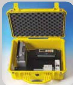
Valise antichoc IP65 case. Complète avec batterie rechargeable (15 Ah) et alimentation/chargeur de batterie (220/13,8 Vdc)
