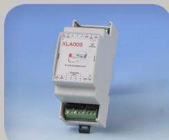
Module pour convertir un signal analogique ou numérique en RS485. Il est possible d'installer plusieurs modules sur le même bus RS485
