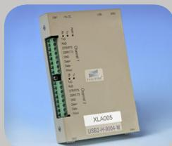
Interface USB avec N.2 entrées RS-232/485. Utile pour augmenter le nombre de capteurs de type série sans utiliser les ports RS232 de X-Log
